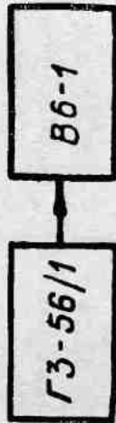
Рис. 6. Схема электрическая структурная проверки коэффициента нелинейных искажений
