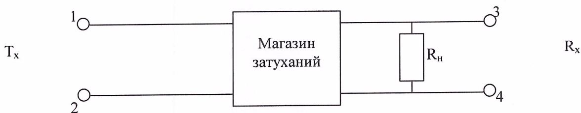
Рисунок 1 – Схема подключения магазина затуханий при определении погрешности измерения вносимых потерь
