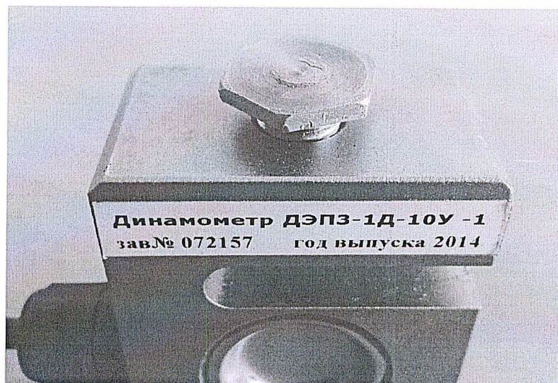
Рис.2 Расположение болта для регулировки люфта
