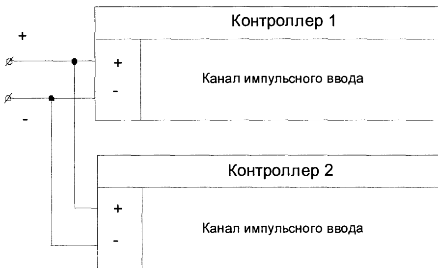
Рисунок 23 – Схема объединения каналов импульсного ввода в схемах резервирования (для рисунков 10, 11, 12 и 13 приложения А)
