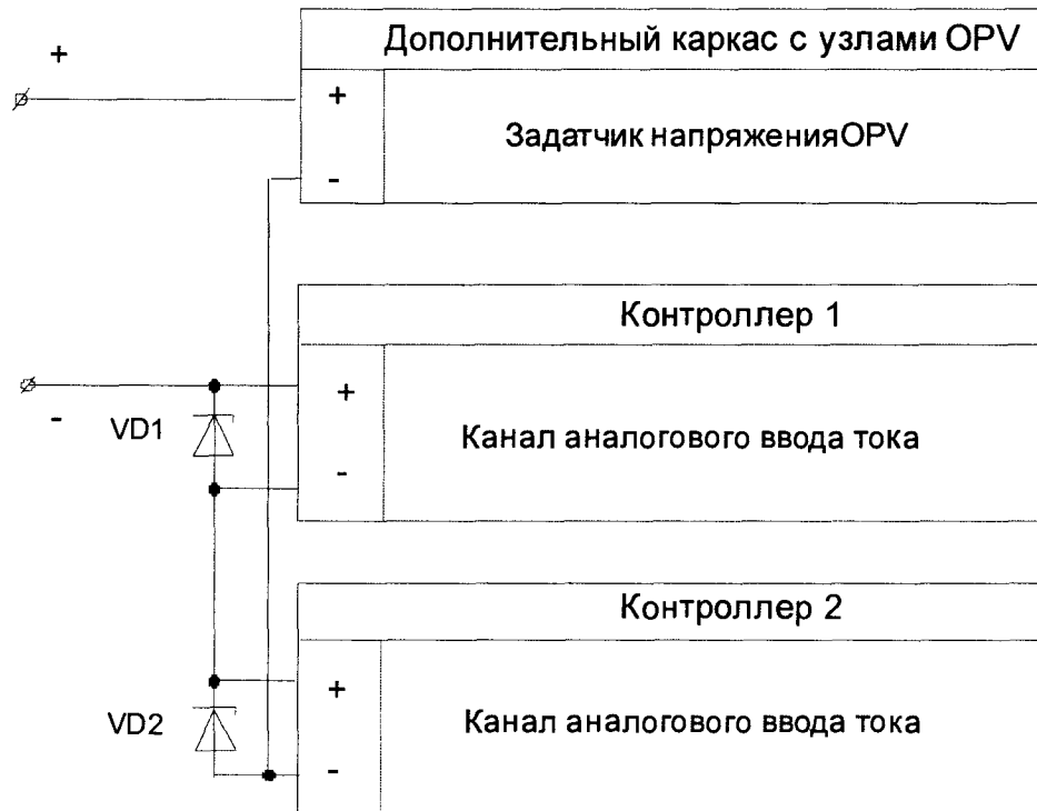
Рисунок 17 – Схема объединения каналов аналогового ввода тока с задатчиком напряжения для питания токовой цепи в схемах резервирования (для рисунка 1б приложения А)
