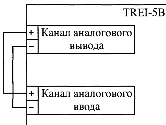
Рисунок 8 – Схема проверки основной приведенной погрешности измерительных каналов аналогового вывода АО-0-20mA, АО-4-20mA, АО-0-5V, АО-0-10V
