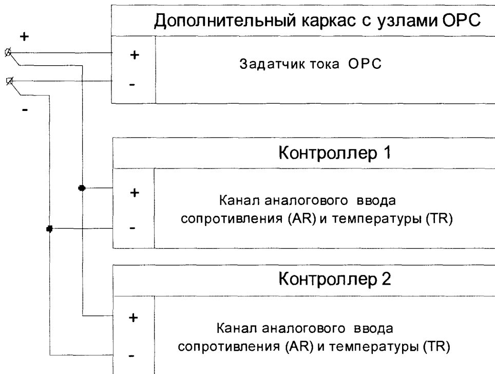
Рисунок 19 - Схема объединения каналов аналогового ввода сопротивления и температуры с помощью термометра сопротивления в схемах резервирования (для рисунка 3 приложения А)
