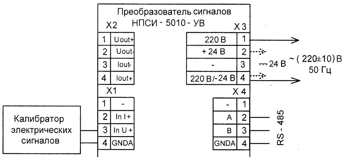
Рисунок 6.4.7.4 – Подключение преобразователя НПСИ-5010-УВ для проведения проверки основной допускаемой погрешности выход по интерфейсу RS-485
