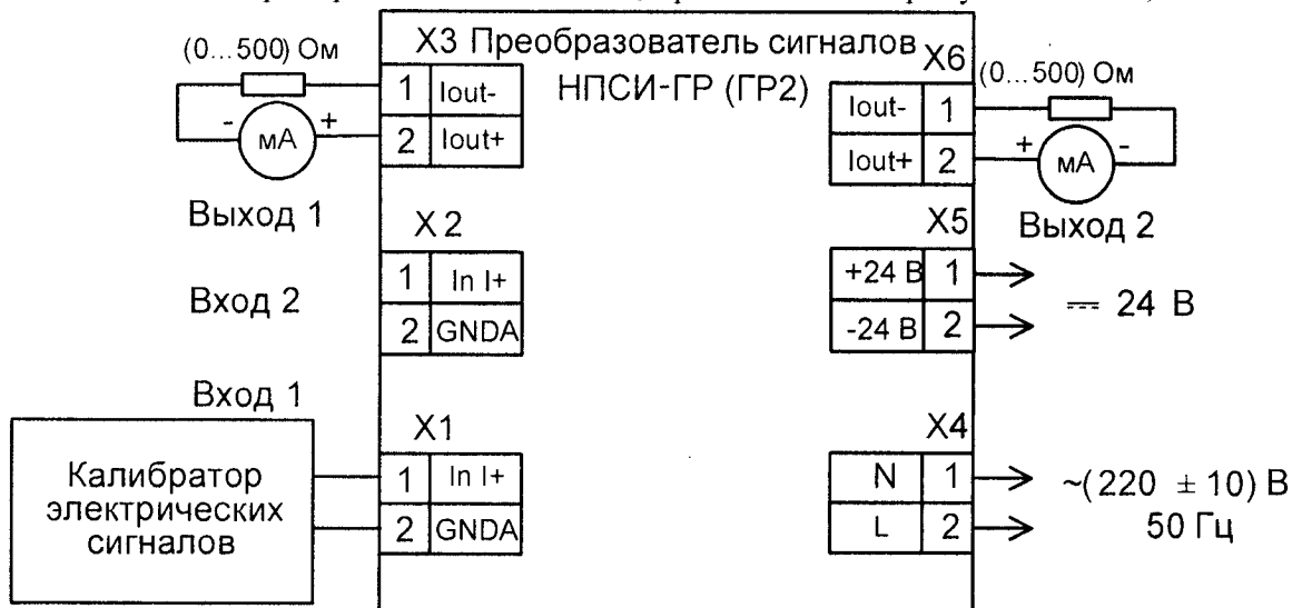
Рисунок 6.4.8.1 – Подключение преобразователей НПСИ-ГР (ГР2) для проведения проверки
