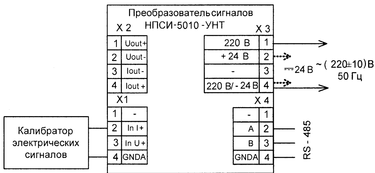
Рисунок 6.4.3.4 – Подключение преобразователя НПСИ-УНТ для проверки сигналов тока, выходной сигнал по интерфейсу RS-485
