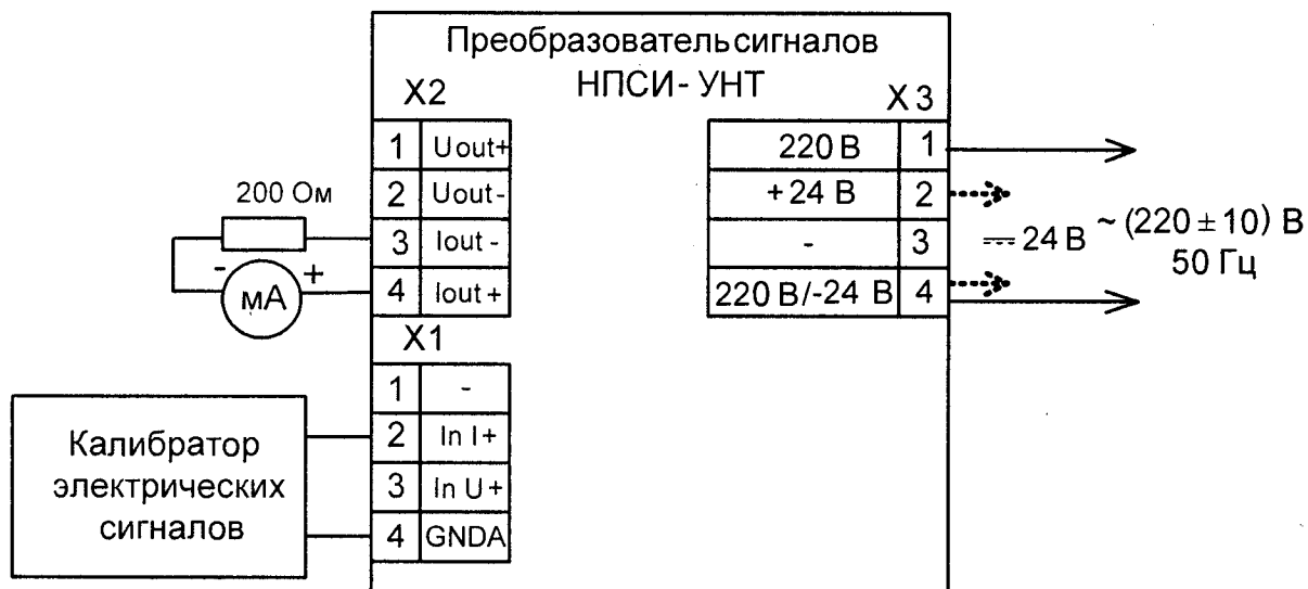
Рисунок 6.4.3.2 – Подключение преобразователя НПСИ-УНТ для проверки сигналов тока, выходной сигнал ток от 4 до 20 мА
