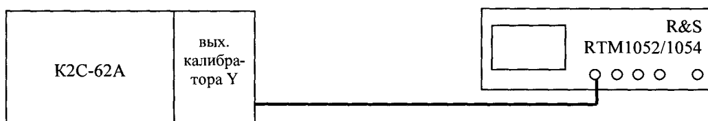
Рисунок 1 - Схема проверки работоспособности и определения погрешности коэффициентов отклонения и погрешности постоянного смещения
