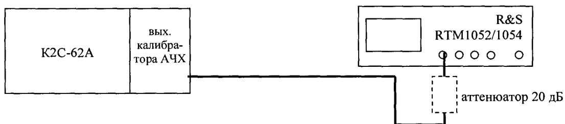
Рисунок 4 - Схема определения минимального уровня синхронизации от входов каналов осциллографа
