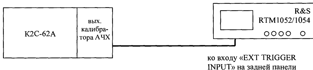
Рисунок 5 - Схема определения минимального уровня синхронизации от входа внешнего запуска
