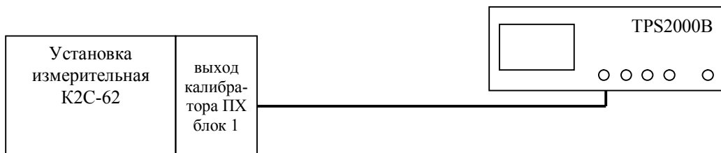
Рисунок 2- Схема определения полосы пропускания осциллографа
