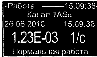
Рисунок 1.6 – Пример вывода информации на ЖК индикаторе УНО-04И (меню "Работа")
