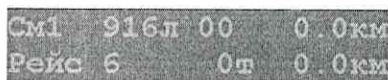
Рисунок 2 – Экранная форма «Смена, объем топлива, скорость, пробег, число рейсов, загрузка, общий пробег»
