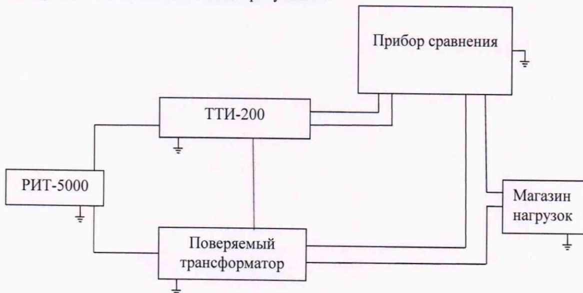
Рисунок 1 – Схема определения токовых и угловых погрешностей
