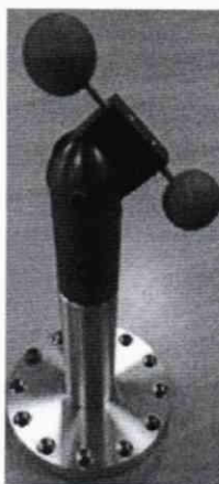
Рисунок 3 – Общий вид меры-диполя для проверки допускаемой основной погрешности измерений диаметров и межцентровых расстояний
