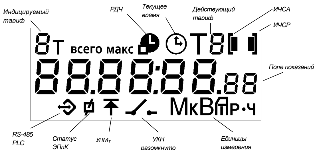
Рисунок Е.1 – Расположение полей дисплея счетчика
