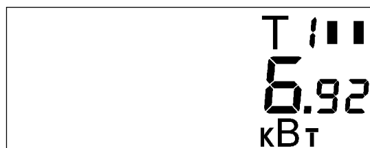
Рисунок Е.14 - Пример индикации текущей активной мощности (текущий тариф по активной энергии– 1)
