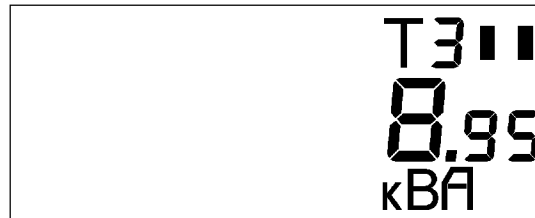
Рисунок Е.15- Пример индикации текущей реактивной мощности (текущий тариф по активной энергии– 2)
