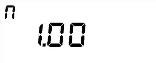
Рисунок Е.4 - Пример индикации версии счетчика
