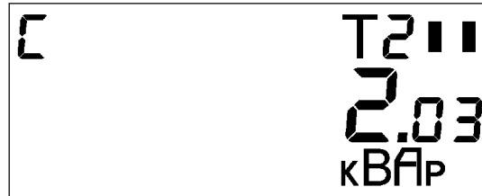
Рисунок Е.15- Пример индикации текущей реактивной мощности (текущий тариф по активной энергии– 2)
