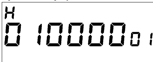
Рисунок Е.2 - Пример индикации заводского номера счетчика (в примере 1000001)
