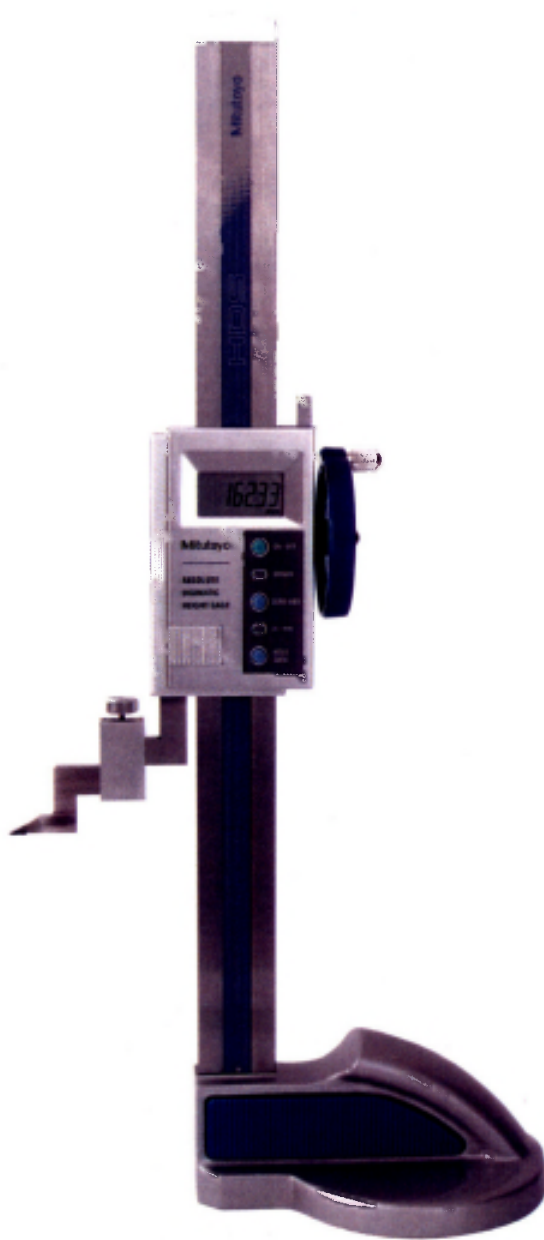
Рисунок 5 – Общий вид штангенрейсмасов серии 570 с большим маховиком
