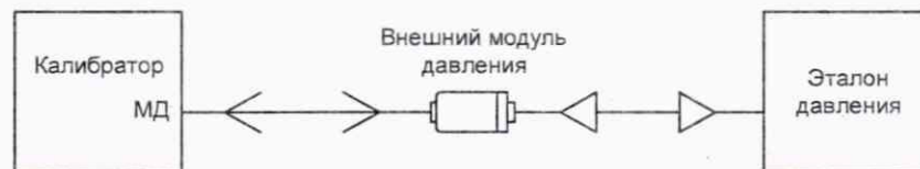
Рисунок А.2 – Схема поверки калибратора в режиме измерений давления внешним модулем давления
