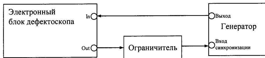
Рисунок 5 - Схема определения временных характеристик приемного тракта дефектоскопа
