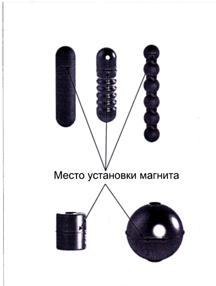
Рисунок А.2 – Положение магнитов внутри поплавков различных типов
