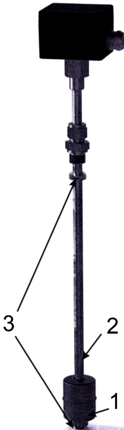
Рисунок А.2 – Схема расположения поплавка при поверке уровнемера с установленным на нем поплавком
