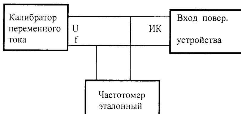
Рисунок 3. Схема проверки каналов измерения частоты переменного тока
