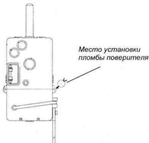
Рисунок 1 – Место установки пломбы поверителя счетчиков, не оснащенных ДДТ
