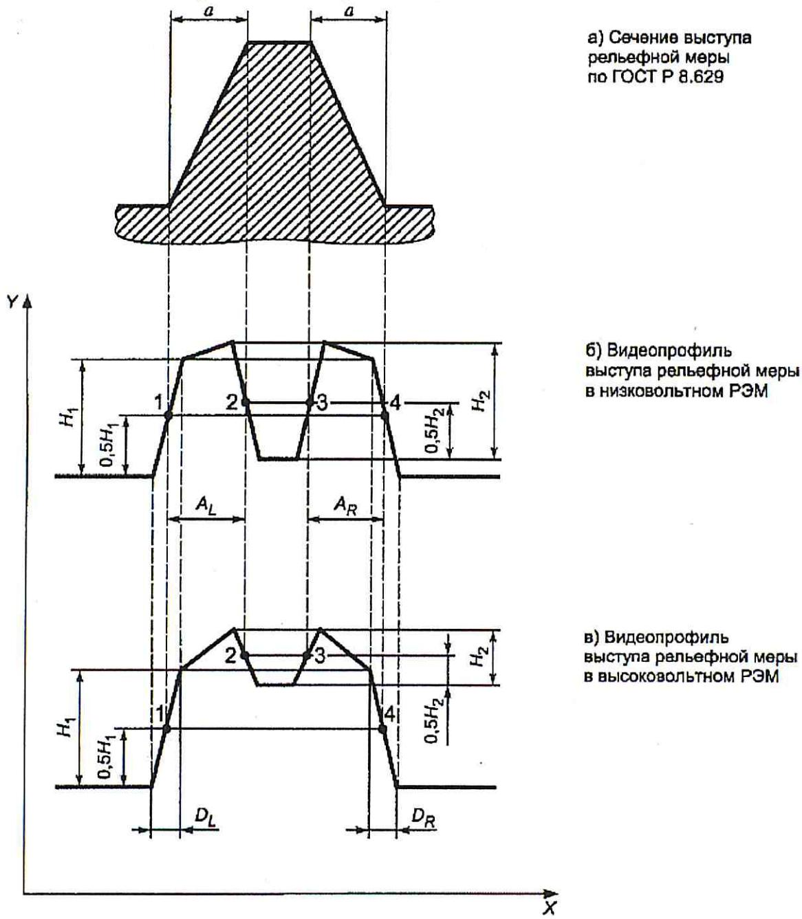
Рисунок 1 - Сечение выступа рельефной меры и его видеопрофили, полученные с помощью микроскопов различных типов.
