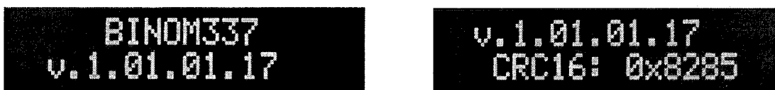
Рисунок 3. Пример отображения идентификационные данные ПО на индикаторе счетчика серии «BINOM3» модификации «BINOM337».
