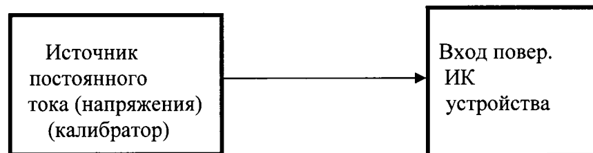
Рисунок 5 Схема проверки основной погрешности ИК аналогового ввода
