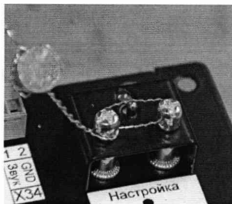
Рисунок А.4 – Пломбирование фиксирующей планки блока индикации и управления «КВАНТ»
