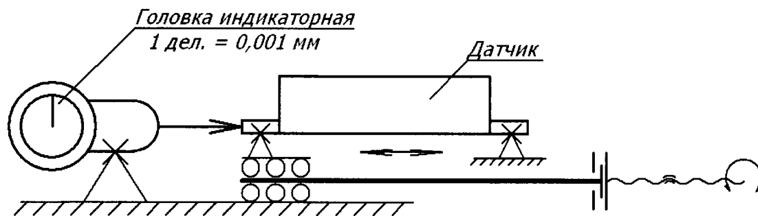
Рисунок 7.6 – Кинематическая схема поверочного стенда для датчика СДД
