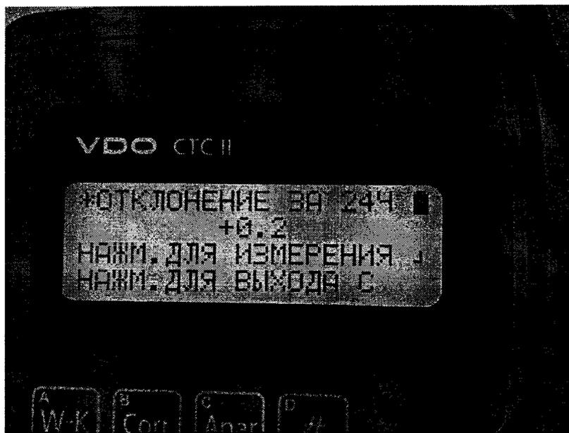
Рисунок 7- Значение погрешности времени на дисплее установки поверочной СТС II.
