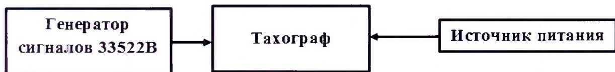
Рисунок 3 – Схема проведения измерений при определении инструментальной погрешности измерения скорости по датчику движения
