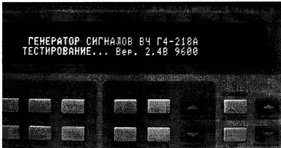
Рисунок 1 – дисплей прибора с идентификационными данными
