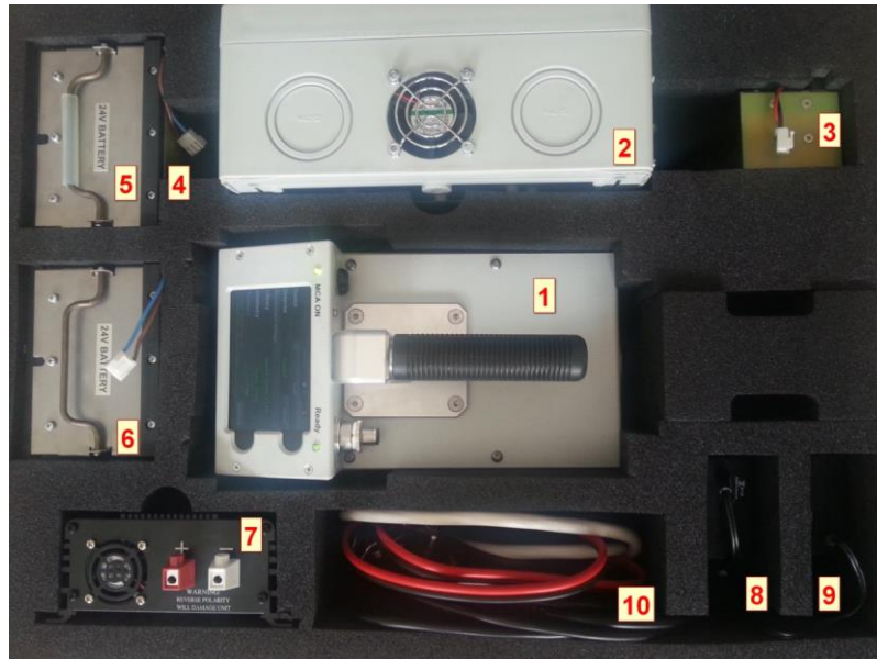
Рис. 5. Расположение составных частей переносного комплекса для вариантов исполнения Эко ПАК-01-2, Эко ПАК-02-2, Эко ПАК-03-2 в едином корпусе «Monolith».
