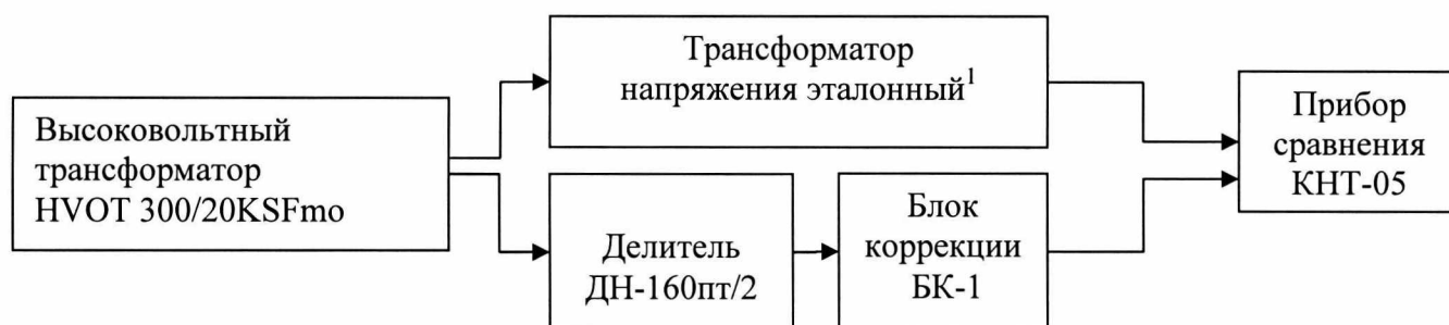
Рисунок 2 – структурная схема подключения приборов для определения основной относительной погрешности коэффициентов масштабного преобразования и основной абсолютной погрешности угла фазового сдвига делителя ДН-160пт/2-БК.
