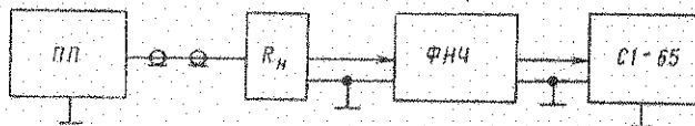
Рис. 8. Структурная схема определения пределов установки постоянной составляющей выходного синусоидального сигнала ( R_n = 50 \text{ Ом} )
