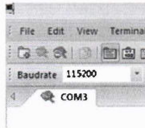
Рисунок Ж.4 - пример активации кнопки «Open port (Alt+O)»
