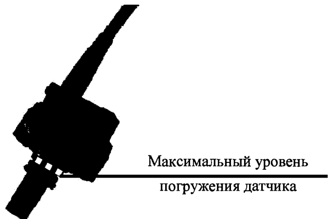
Рисунок Б.3 – Допускаемый уровень погружения датчика модели RPS в измеряемую среду при поверке.
