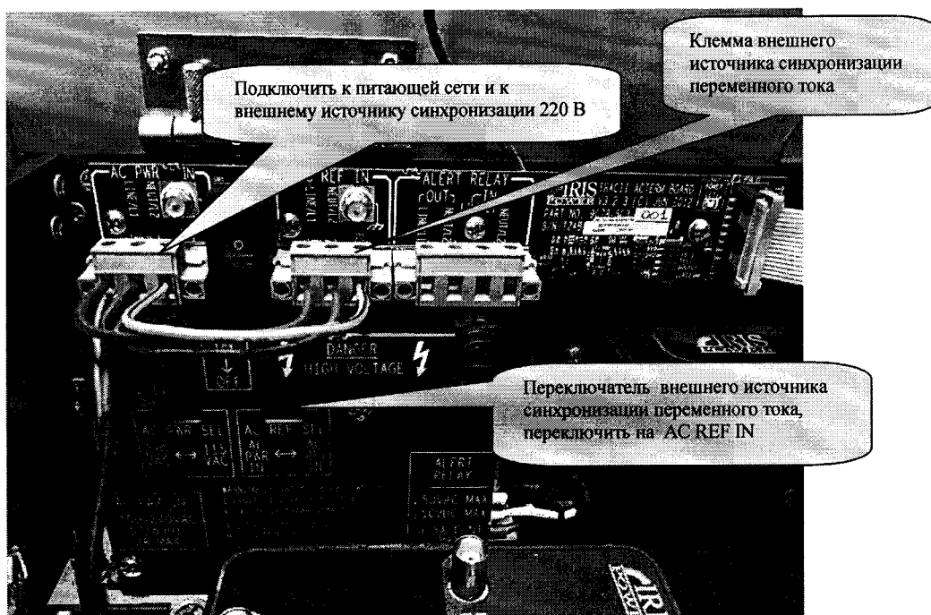
Рисунок 1 – Схема подключения системы модификации PDTracII к питающей сети
