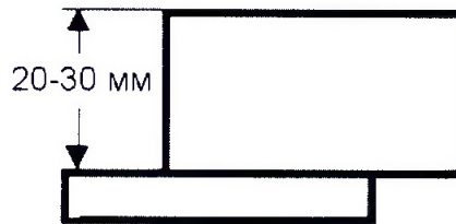
Рисунок 1 - Ступенька из концевых мер длины для определения абсолютной погрешности измерений по оси Z
