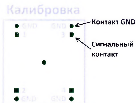
Рисунок 13 – Контакты для калибровки устройства ТСКЯ.418133.416
