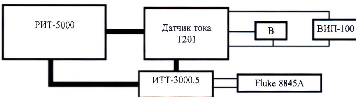
«V» - мультиметр Fluke 8845A в режиме измерения напряжения постоянного тока. Рисунок 6 – Схема измерений силы переменного тока для датчика с выходным сигналом от 0 до 10 В
