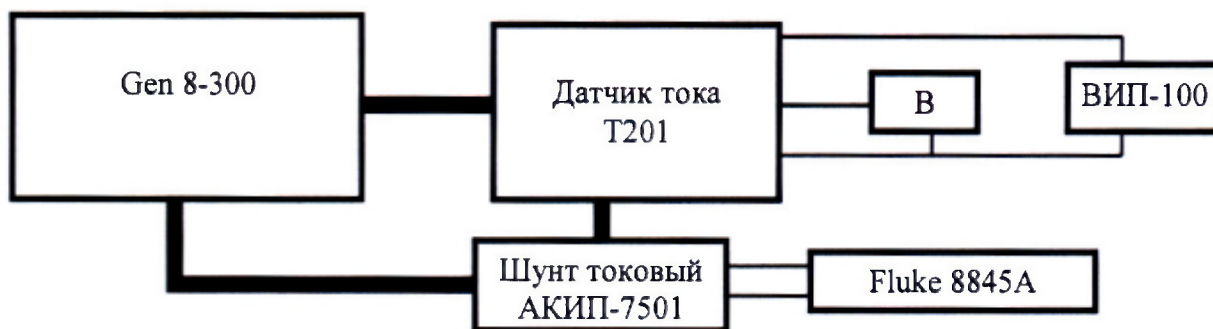
«В» - мультиметр Fluke 8845A в режиме измерения напряжения постоянного тока. Рисунок 4 – Схема измерений силы постоянного тока для датчика с выходным сигналом от 0 до 10 В
