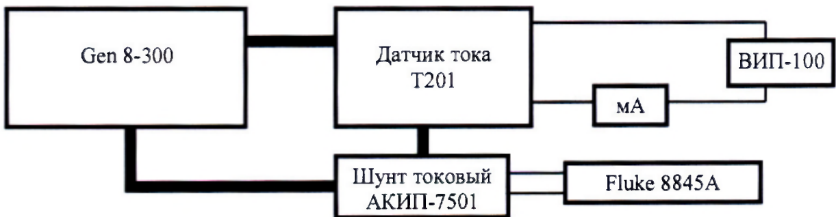
Рисунок 3 – Схема измерений силы постоянного тока для датчика с выходным сигналом от 4 до 20 мА
