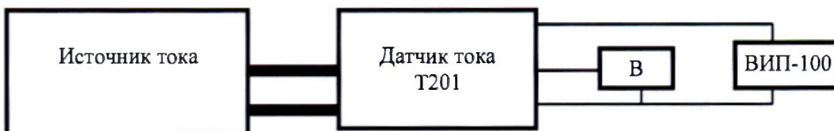
Рисунок 1 – Схема измерений силы постоянного и переменного тока для датчика с выходным сигналом от 4 до 20 мА
