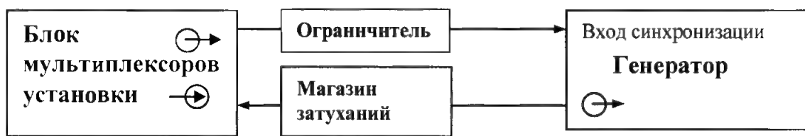
Рисунок 4 – Схема соединения для определения линейности по вертикали, определения абсолютной погрешности измерений амплитуд сигналов на входе приемника
