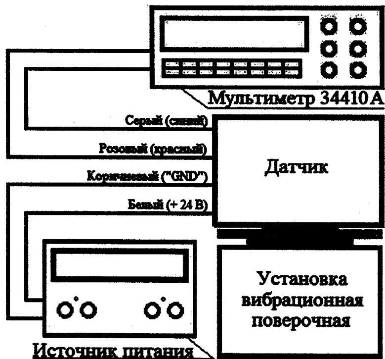
Рисунок 2 – Схема измерений при проверке установленного порога срабатывания
