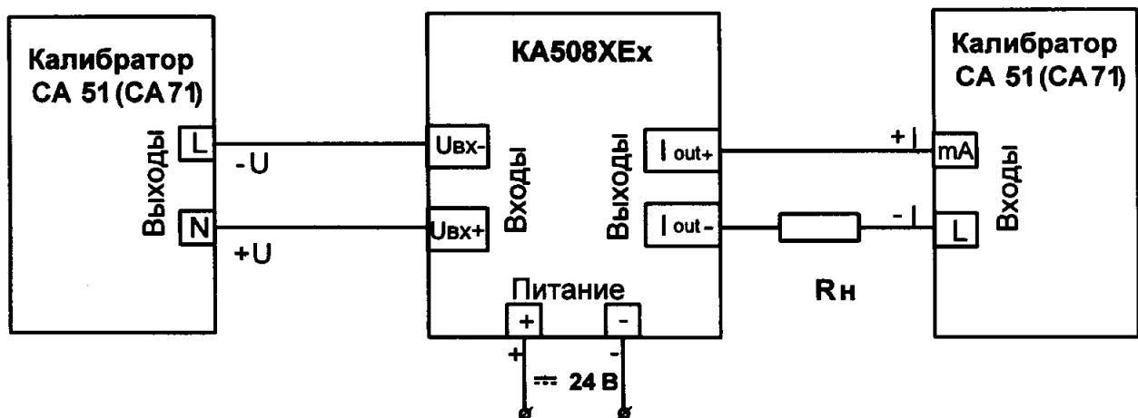
Рисунок 6.9.1– Подключение барьера КА508ХЕх для проверки преобразования сигналов напряжения в диапазоне от минус 5 до 0 В, выходной сигнал - ток от 4 до 20 мА
