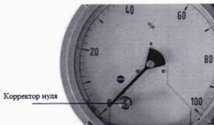
Рисунок 2 – Установка стрелки на нулевую отметку шкалы у модели Media 5
