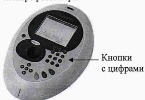
Рисунок 4 – Расположение кнопок с цифрами на корпусе спектрофотометра
