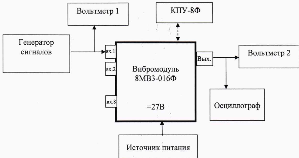
Рисунок 2 - Схема измерения амплитудных и амплитудно-частотных характеристик вибромодуля 8МВ3-016Ф
