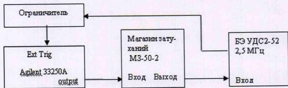
Рисунок 3 - Стенд для измерения параметров затухания и времени
