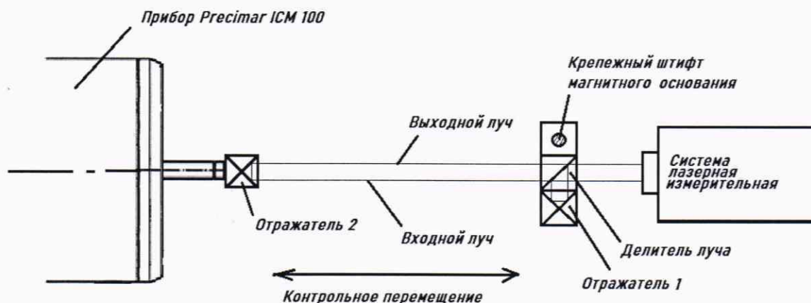
Рисунок 2. Схема установки оптических элементов и лазерной измерительной системы при поверке в горизонтальном положении (вид сверху)
