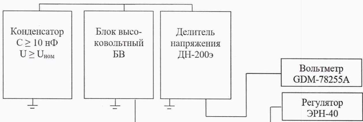
Рисунок 2 - Схема определения погрешностей измерений напряжения постоянного тока
