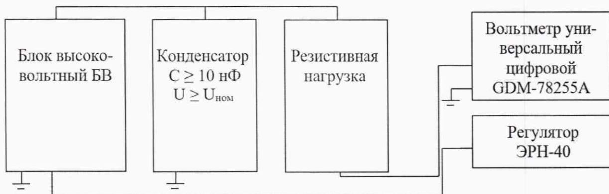
Рисунок 4 - Схема определения погрешности измерений силы постоянного тока
