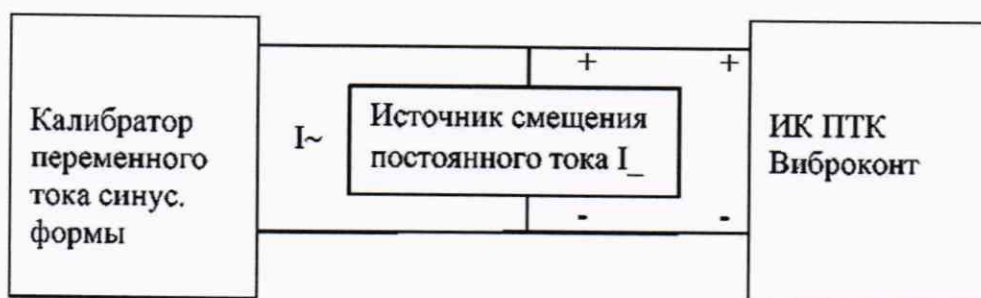
Рисунок 3 - Схема определения погрешности ИК размаха и СКЗ вибропараметров ПТК Виброконт с входным сигналом силы переменного тока
