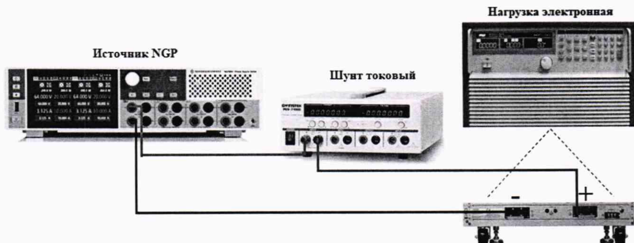
Рисунок 5 – Структурная схема соединения приборов для определения нестабильности силы тока на выходе источников
