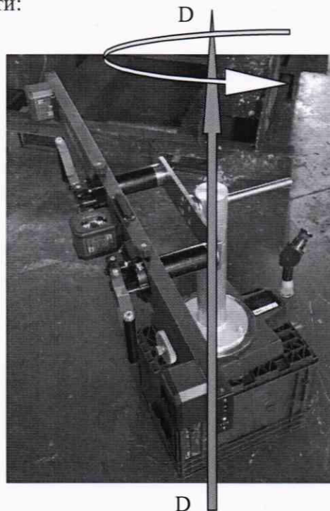
Рис. 1. Схема измерений углов индивидуального схождения ступиц
