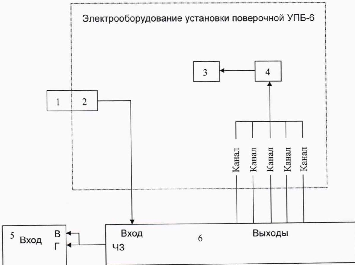
1 - счетчик газа; 2 – датчик импульсов; 3 – компьютер;
