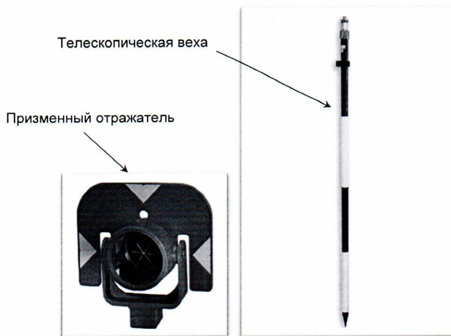
Рисунок А.1 – Веха телескопическая с призмным отражателем
