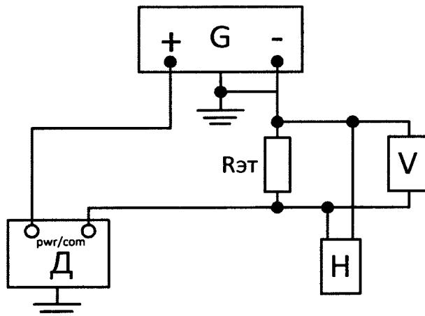
Д – поверяемый преобразователь;
