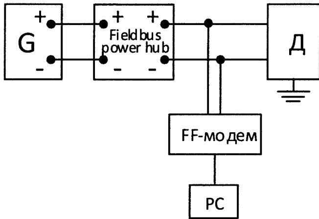
FF-модем – Преобразователь интерфейса Fieldbus – USB для связи преобразователя с компьютером;
