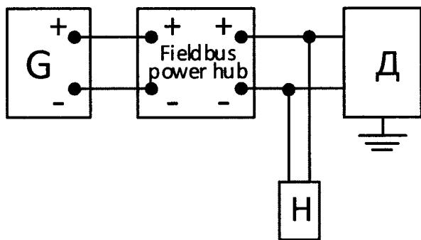
Fieldbus power hub – Распределительная коробка для сегмента шины Foundation Fieldbus;
