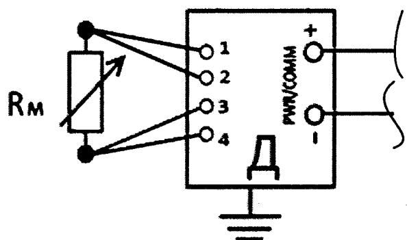
$\Delta$  – поверяемый преобразователь;
