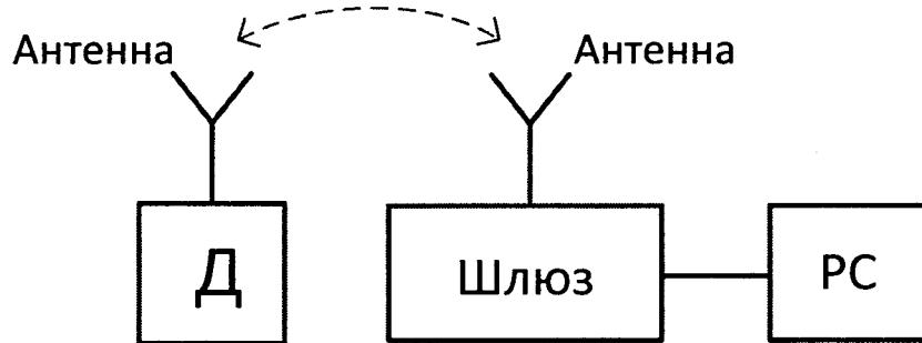
Шлюз – Устройство для беспроводной связи с преобразователем по цифровому каналу Wireless HART;
